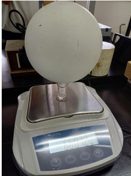
Pesando la esfera sobre recipiente de plástico (tarado).
